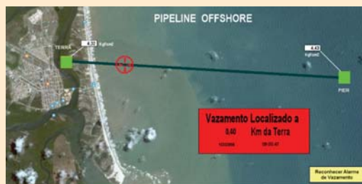
Figura 6: Tela do operador na ocorrência de um vazamento.
