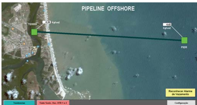
Figura 6: Tela do operador na ocorrência de um vazamento.
