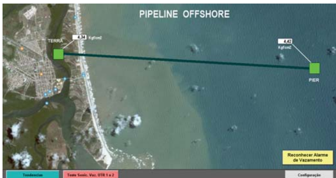
Figura 5: Tela do operador em condições normais de operação.
