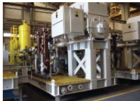
Compressor do tipo parafuso fabricado pela Mycom Chemical do Brasil para a P-54
