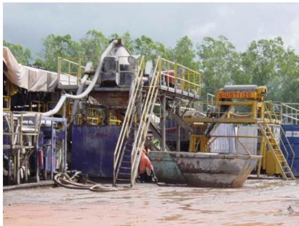
Figura 2 – Processo de secagem do cascalho de perfuração no poço ANB-03
